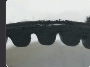
心線が破損し、ヒビが出ている。下記の表からするとDの状態。
